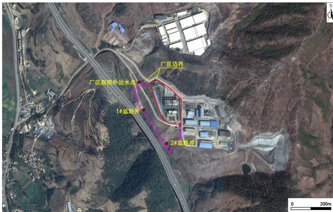
图 5.2.3-7 地下水污染监控井布设图
